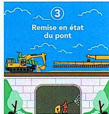
**Repose des composants de la voie (rails, traverses et ballast) afin de permettre la reprise des circulations ferroviaires.**
